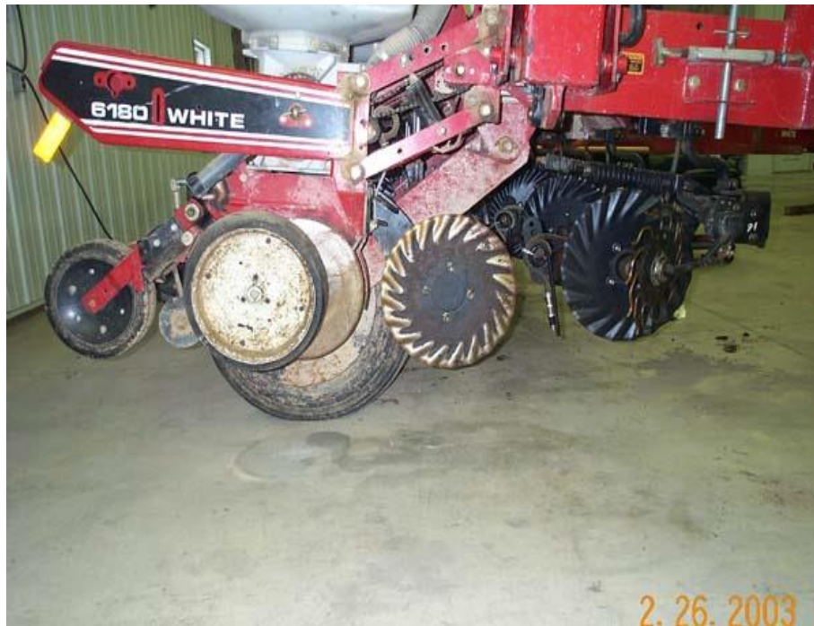
Figura M21 Sembradora adaptada para la siembra sobre rastrojo en la Labranza de Conservación, con discos cortadores de paja al frente
